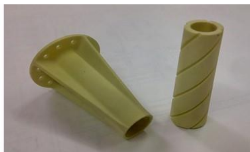
Радиопрозрачные элементы корпуса спиральных антенн для микроспутника
